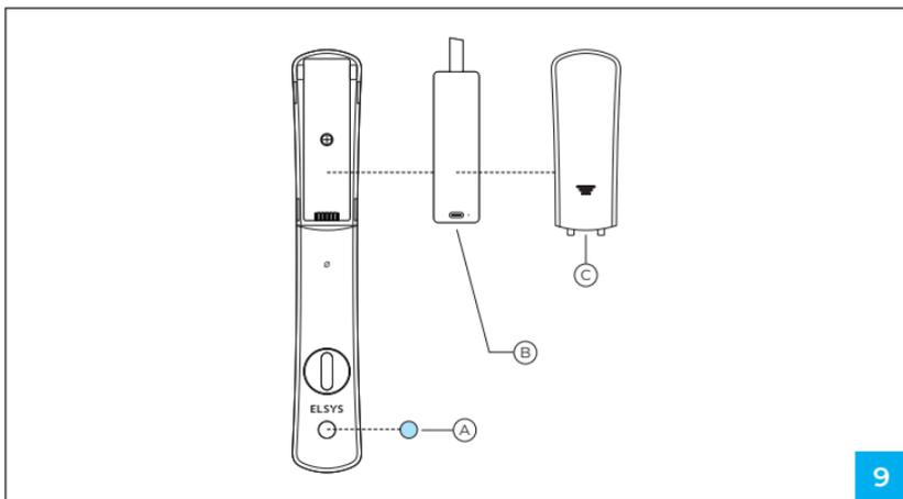
**9.** Insira o acabamento de silicone no parafuso interno **(A)**.
