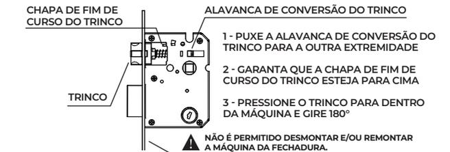
**5** Fixe a máquina na porta utilizando 2 parafusos de M4,2 x 16mm ou M4 x 25mm. Utilize os parafusos adequados para o material de sua porta.
