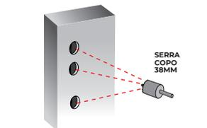
**3** Posicione o gabarito para realizar as marcações necessárias para inserir a máquina da fechadura na lateral da porta, garantindo que as marcações estejam centralizadas na espessura da porta. Em portas com 35 mm de espessura, dobre o gabarito na linha pontilhada e faça as marcações. Para portas com espessura superior a 35 mm, separe o gabarito na linha pontilhada e centralize a parte menor na lateral da porta.
