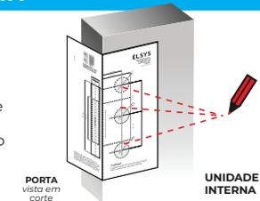
**2** Use uma serra copo de 38mm para realizar as furações conforme as marcações.
